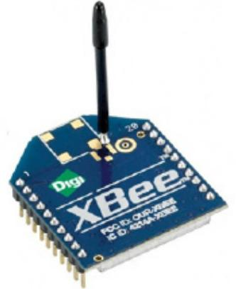
Nous avons aussi choisi d'utiliser ces modules XBee car ils consomment peu d'énergie et car ils possèdent un mode «sleep» permettant d'éteindre par intermittence le module. Un autre avantage est la portée qui peut aller avec certains modules XBee jusqu'à 1500 mètres, mais dans notre cas nous sommes limité à l'utilisation d'un module XBee disponible à l'école mais ayant une plus courte portée (dans les 20 mètres avec obstacles).
