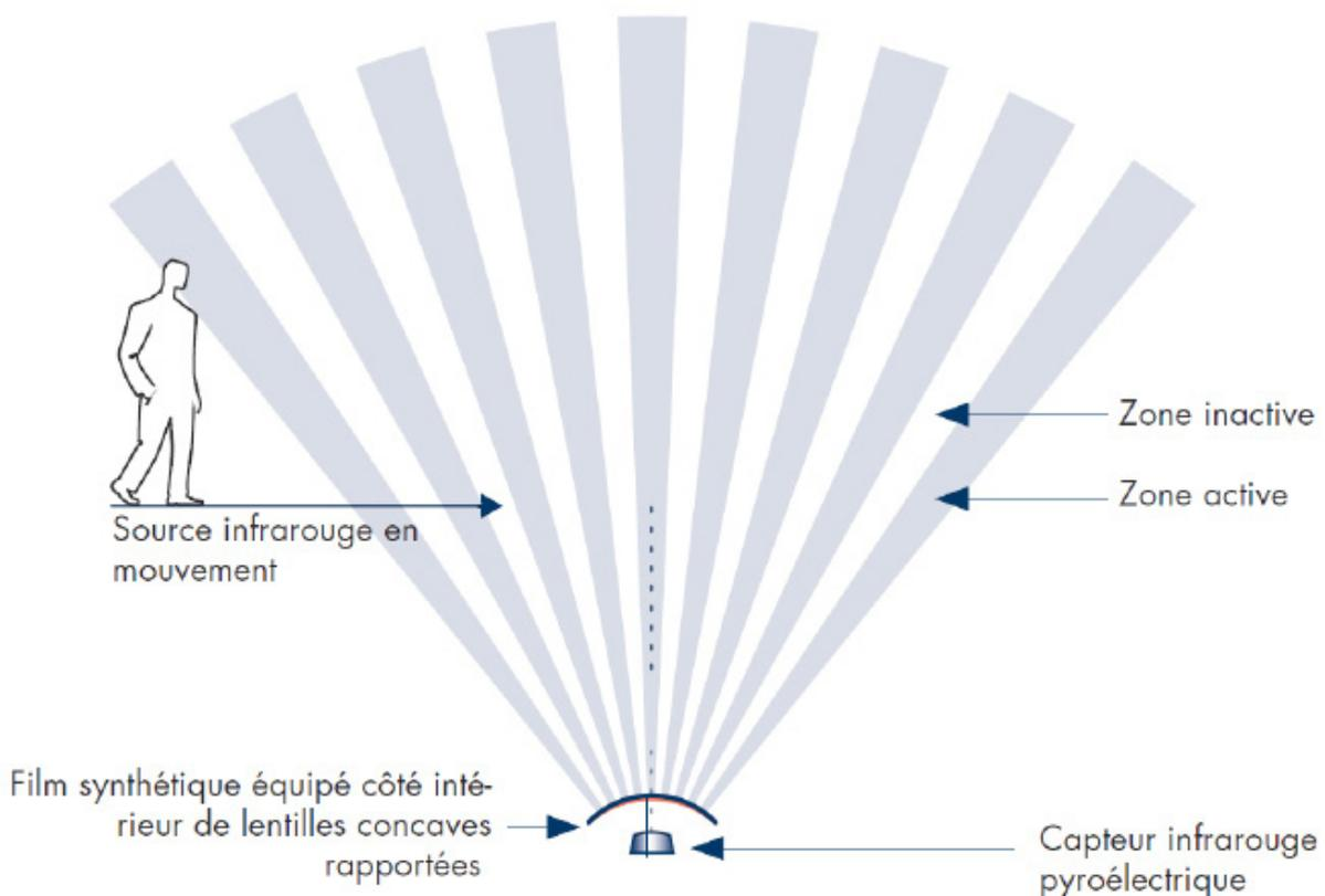
Ce système optique divise, grâce à des lentilles multiples, la zone de détection en un grand nombre de zones actives et inactives. Si une source de chaleur passe d'une zone à une autre, le capteur pyroélectrique envoie un signal qui est traité par un microprocesseur pour commander un système d'alarme.
