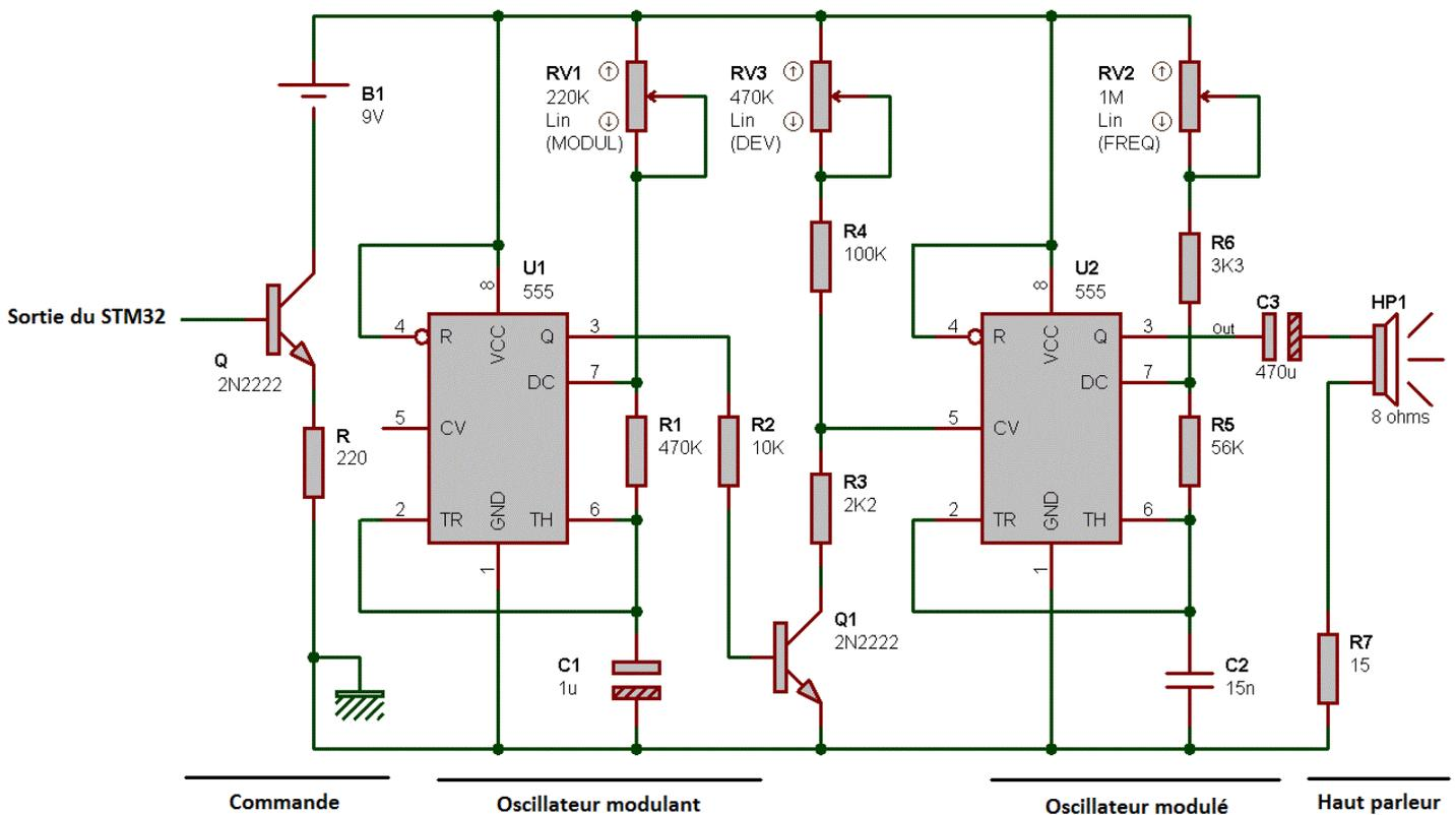
La sirène que nous avons conçue est de type bitonale. Cela signifie que l'on entend deux sons de fréquence fixe alternés (cf image ci-dessous). Il existe d'autres types d'alarmes comme les alarmes modulées qui ont une variation continue de la fréquence.
