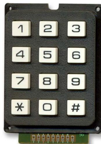
Pour savoir si une personne appuie ou non sur une touche, il faut se positionner sur la colonne en question (on envoie un 1 logique sur la colonne choisie et un 0 logique sur les deux autres).
