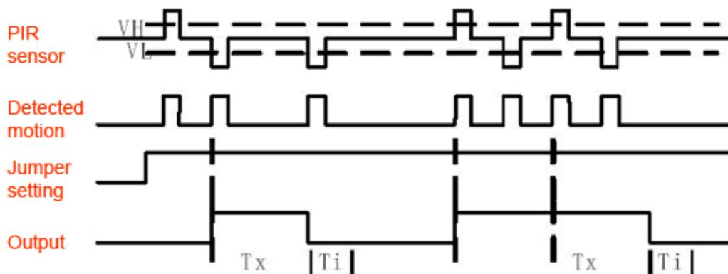
Voici un oscillogramme de la sortie de notre capteur PIR : on distingue bien les deux temps, celui de la détection de mouvement, et l'absence de détection.
