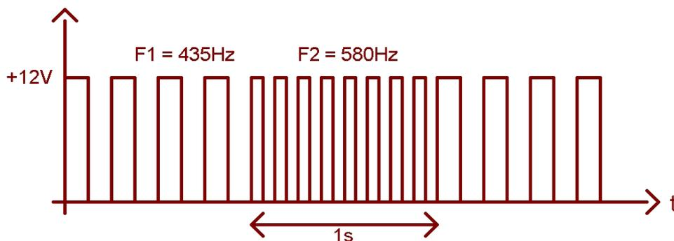
Nous utilisons ici deux NE555 en mode astable. Cela nous permet, avec une tension continue en entrée d'avoir un signal carré avec une fréquence et un rapport cyclique réglables en sortie. Voici le branchement et les caractéristiques en sortie de ce mode de fonctionnement :
