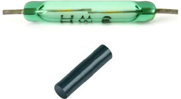
Le contact à ouverture que nous avons choisi dispose d'une protection particulière contre le sabotage : si un aimant étranger au système est disposé à côté de l'aimant du système, ce dernier reconnaît le champ magnétique (modifié). Le contact Reed NC s'ouvre ensuite.
